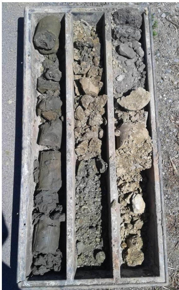
Foto 1, 2 Hloubení sondy J-1 a její petrografický profil
