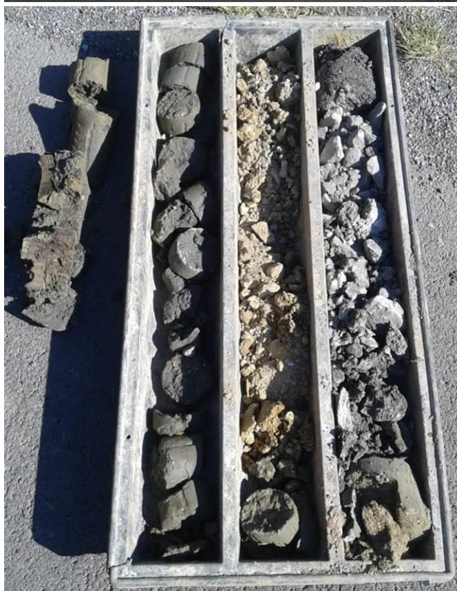
Foto 9, 10 Hloubení sondy J-5 a její petrografický profil
