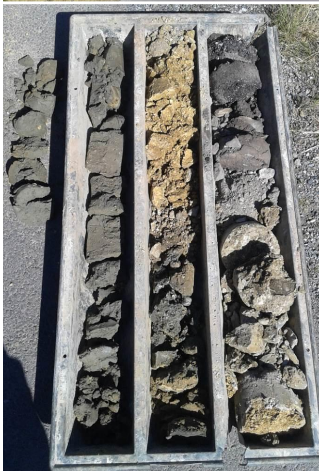
Foto 7, 8 Hloubení sondy J-4 a její petrografický profil
